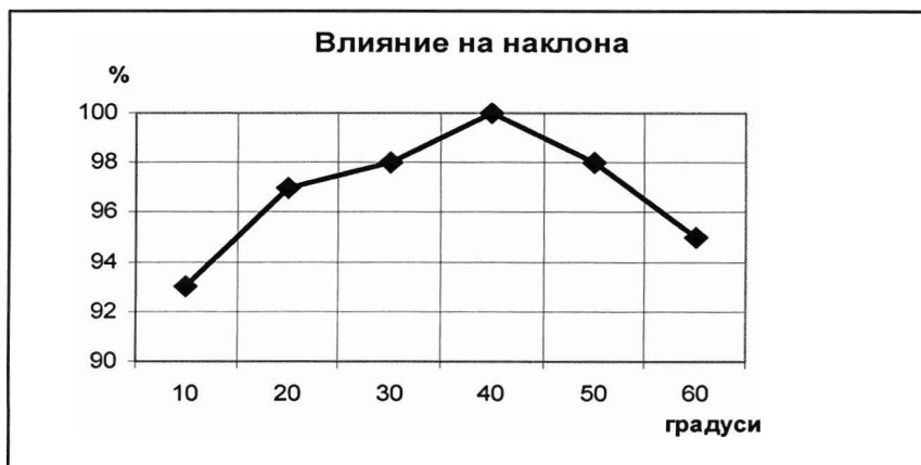
Фигура 6.1.2: Влияние на ъгъла на наклона върху количеството на приетата слънчева енергия
